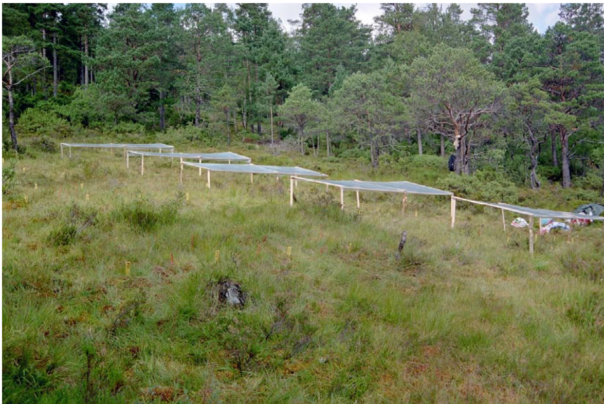
Figur 3. Felt A på bakkemyr i åpen furuskog. Nedbørsimulerte ruter til venstre i bildet. Tørkesimulerte ruter under plastduk til høyre.
