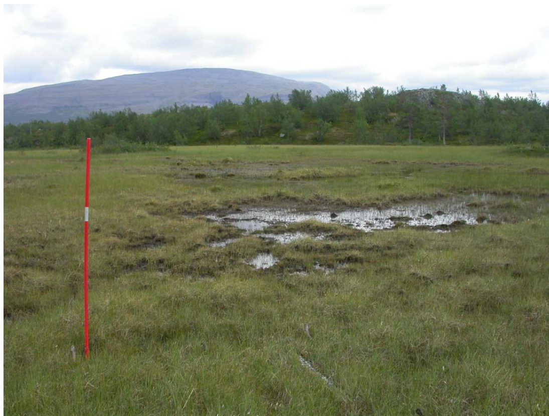
Figur 14. Trasé 5 med geonett (4-hjuling) på myra fotografert sommeren 2007. Kjøresporet er nå vanskelig å se. I tillegg er det blitt kanalisert mer vatn inn i myra og større deler av myrvegetasjonen lå under vann i 2007. Dette kan ha sammenheng med utbedring av Halkavarveien og nytt dreneringsrør i andre enden av vannet som ligger inntil myra.
