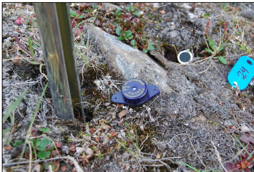
Figur 4. Metodikk for utlegging av dataloggere. Jordbor, datalogger med snøre og merkelapp og aluminiumsrør som viser hjørne av analyseruta. Foto: O.E. Stabbetorp.
