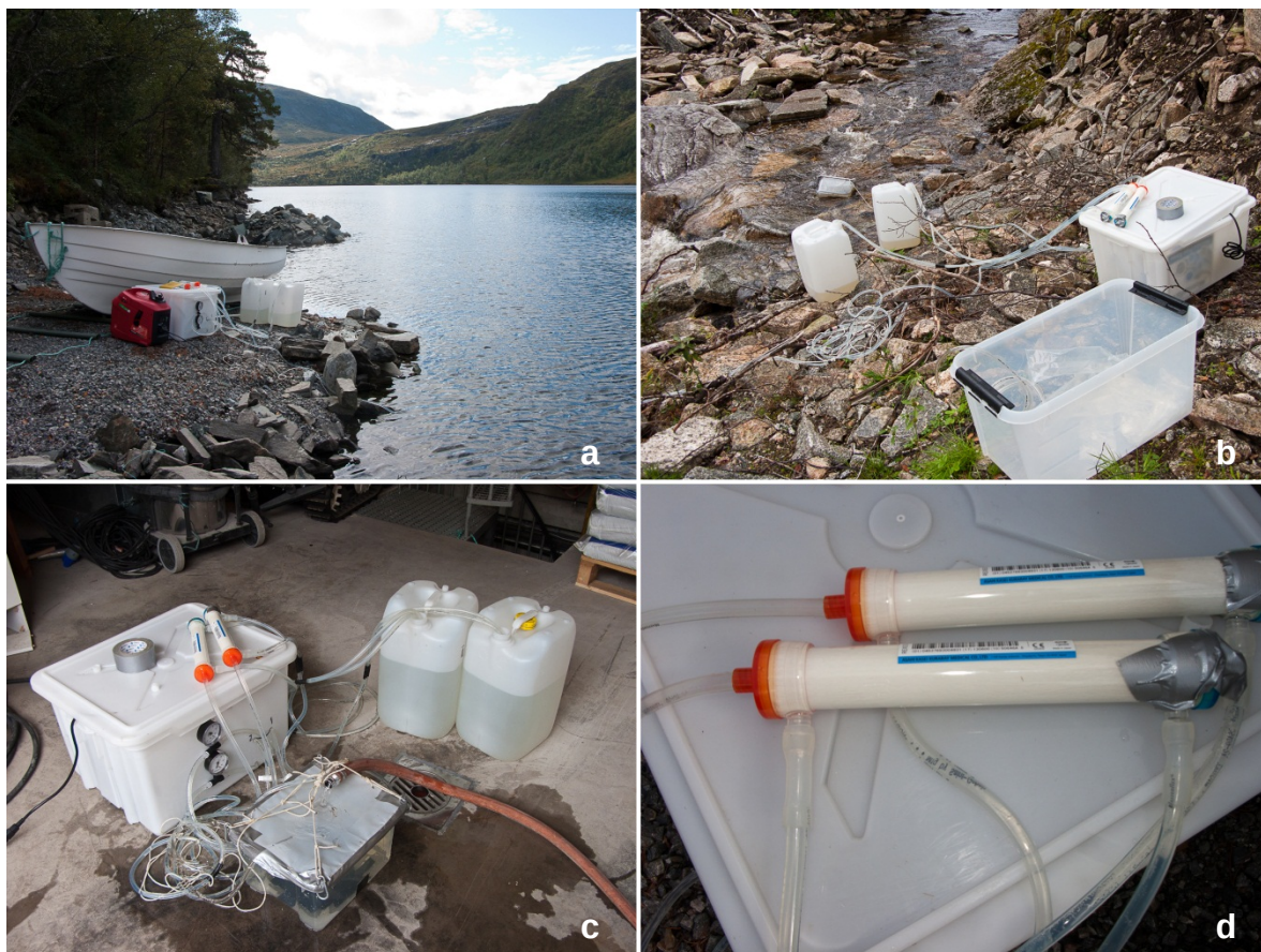
Figur 2.4. Vannprøver for analyse av krepsepestsporer ble tatt i Skittenholvatnet (a), Oppsalvatnet, Spjøta (b) og fra Genbanken på Haukvik (c) ved hjelp av ultrafiltrering av 2 parallelle prøver a 100 til 150 liter vann. Vannet ble prefiltret gjennom en planktonduk (90 \mu\text{m} ), og deretter ble øvrig mikrobielt innhold oppkonsentrert ved hjelp av peristaltisk pumpe og ultrafiltrering gjennom dialysefiltere (d).
