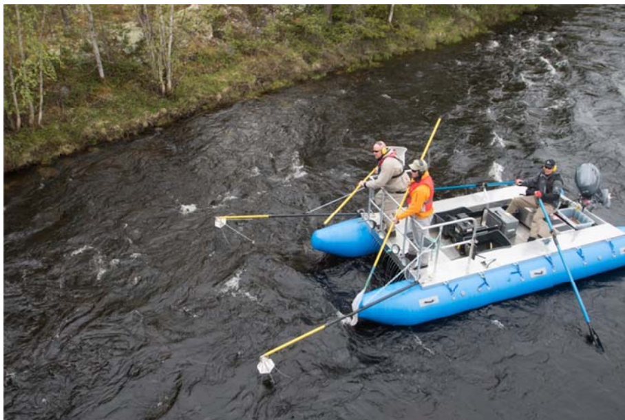
Bilde 2 Elfiskebåt av typen CATARAFT som er tilpasset bruk i strømssterke og grunne elver (foto: Børre K. Dervo).
