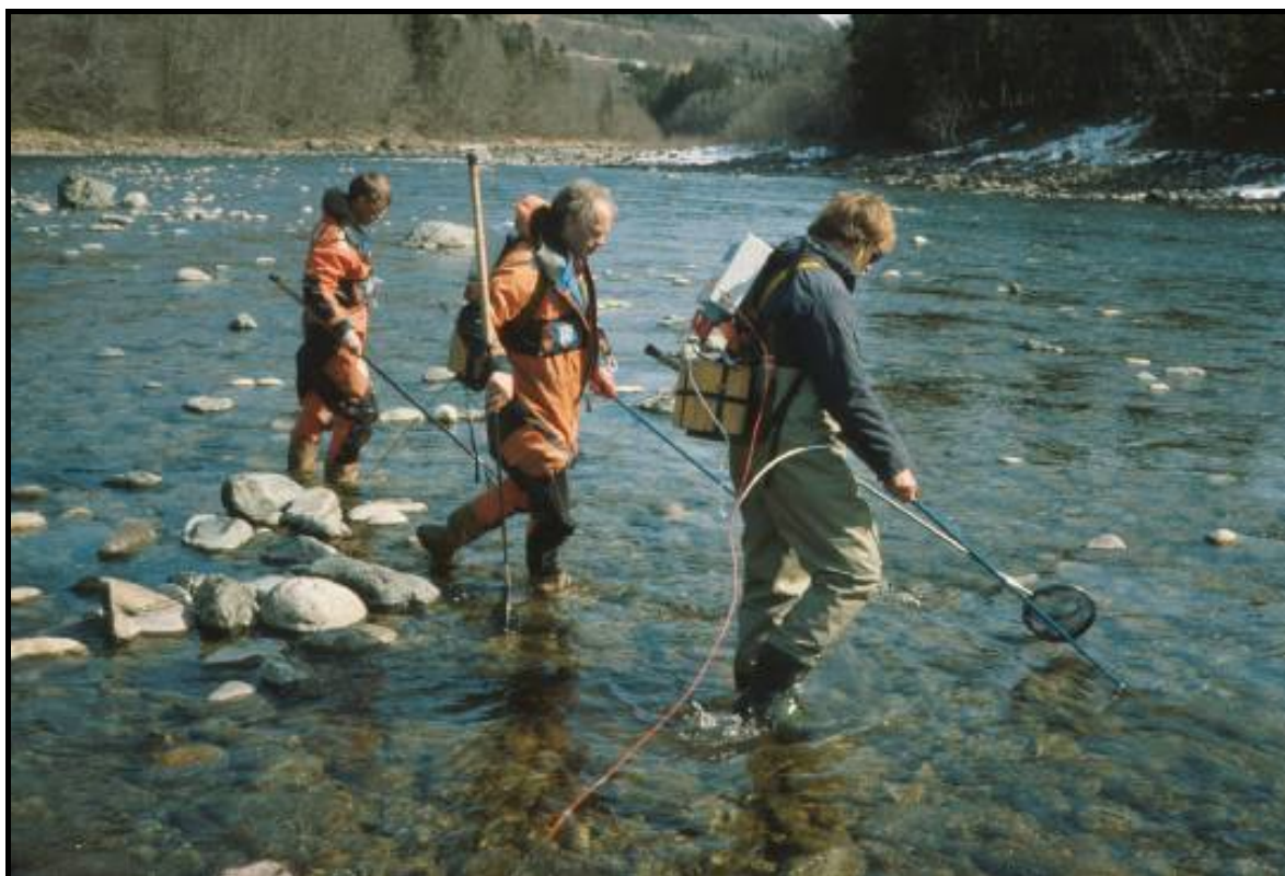
Bilde 4. Av sikkerhetsmessige og praktiske grunner (fangsteffektivitet) bør man være minst to personer når man utfører elektrisk fiske. Enkelte steder som i Orkla kan det være hensiktsmessig å bruke to elektriske fiskeapparat.
