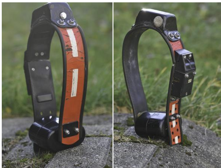
Figur 10. Foto av GPS-sender fra VECTRONICS og som er brukt i dette prosjektet. Antennen for satellitt og GSM signaler sitter i kapselen på toppen av senderen, batteriet i den nederste ovale kapselen. Legg også merke til nummereringen på halsbåndet og den elektroniske utløserenheten på bildet til høyre som seinere er erstattet med en bruddsone i bomull.
