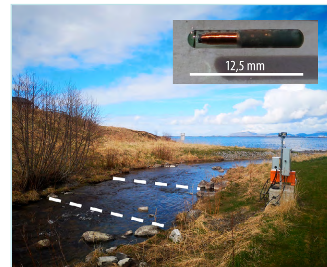
PIT-antenne ved Heggaelva som overvåker ut- og oppvandring av fisk. (Innfelt - en 12 mm PIT-tag)
