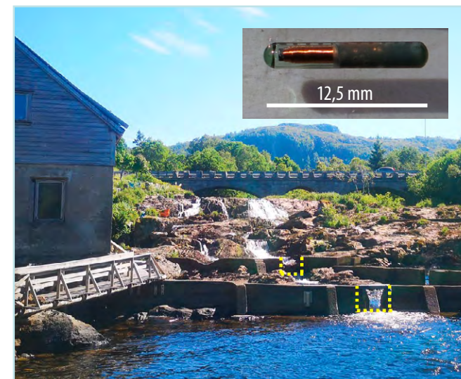
PIT-antenne ved Oselva som overvåker ut- og oppvandring av fisk. (Innfelt - en 12 mm PIT-merker) Antennen skal erstattes av en ny U-formet antenne høsten 2021.
