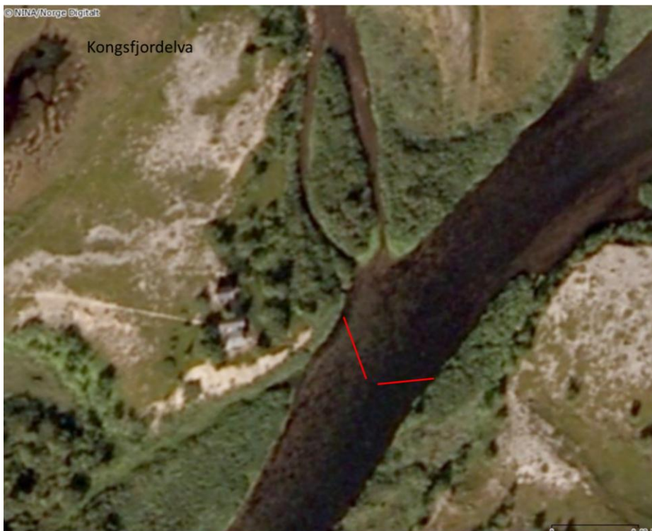
Figur V2. Flyfoto med av området i nærheten av foreslått registreringslokalitet. Omtrentlig plassering av ledegjerdene som har blitt benyttet til videoovervåking er tegnet inn.
