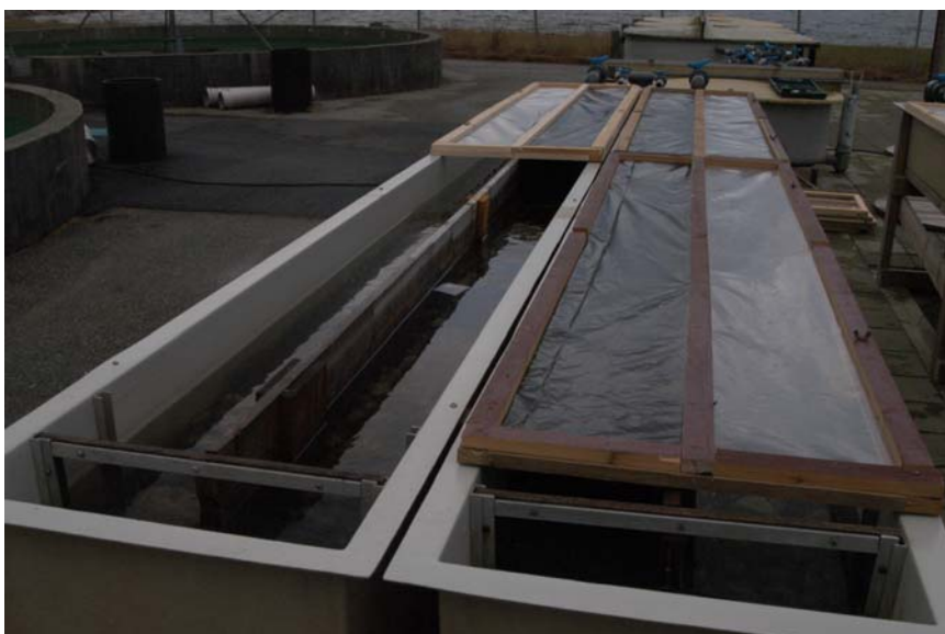
Figur 2. Renner brukt til å simulere 100% isdekke (lystett dekke) og mangel på isdekke (gjennomsiktig dekke).
