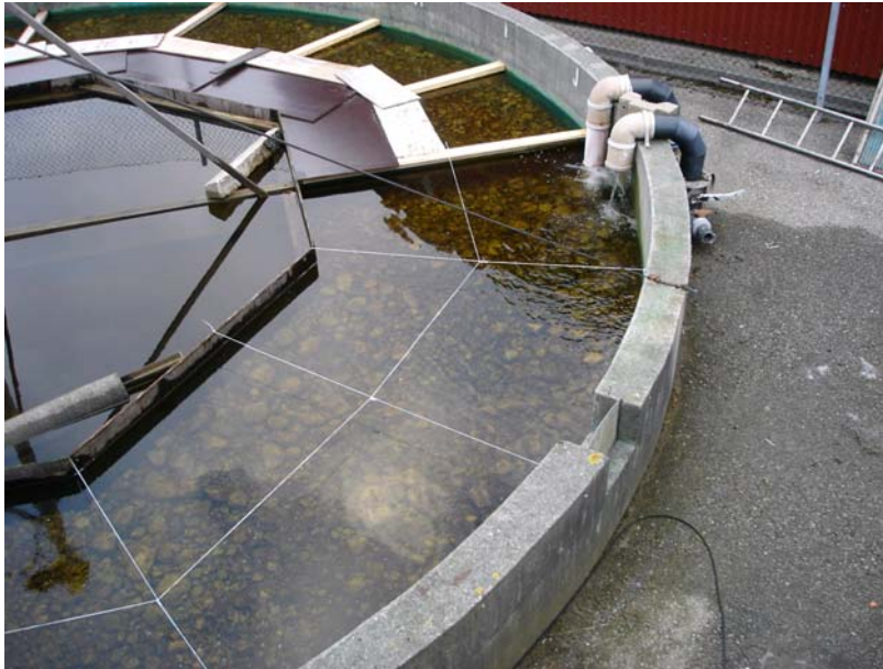
Figur 3. Renner brukt for å simulere delvis (50%) isdekke og mangel på isdekke. Hver av de sirkelformete rennene ble delt på tvers av strømretningen i to like deler. En av delene brukt til å simulere 50% isdekke og den andre til å simulere mangel på isdekke.
