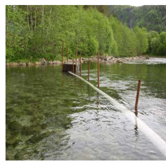
Bilde 1. Rør fra øvre til nedre fangstkasse, slik som det ble montert i 2007. Bildet til venstre viser innsiden av øvre fangstkasse. Bildet til høyre viser nedre fangstkasse, som stod nærmere land og på roligere vann. På bildet i midten ser en oppover mot øvre fangstkasse.
