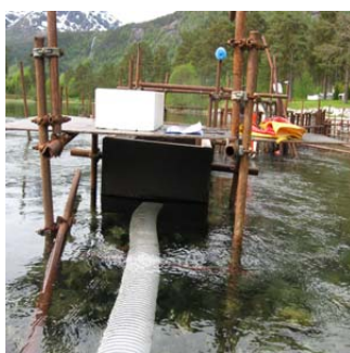
Bilde 1. Rør fra øvre til nedre fangstkasse, slik som det ble montert i 2007. Bildet til venstre viser innsiden av øvre fangstkasse. Bildet til høyre viser nedre fangstkasse, som stod nærmere land og på roligere vann. På bildet i midten ser en oppover mot øvre fangstkasse.
