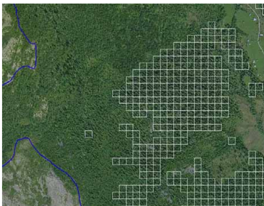
Figur 30. Piksler angitt som tett barskog er angitt som hvite kvadrater; utsnitt fra den østvendte lia (snaufjellområdet er i sørvest). Sammenhengende områder synes å gi et riktig inntrykk. Særlig i østlia gir klassen god visuell overensstemmelse med ortofoto. Orthophoto of a section of the eastern slope overlaid by pixels (each 30 x 30 m) classified as dense coniferous forest (white). Larger contiguous areas seem satisfactorily classified.
