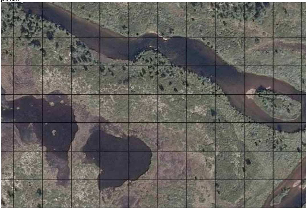
Figur 4. Pikslene fra vegetasjonskartet (svarte ruter) over et ortofoto fra et område nord for Møsvatn (se kapittel 3.2.1). Legg merke til kanteffekten langs elv og små tjern. Skala: rutene er på 30x30 meter. The pixels from the vegetation map (black squares, 30 x 30 m) shown together with an orthophoto north of Møsvatn. Notice the edge effect along water bodies.
