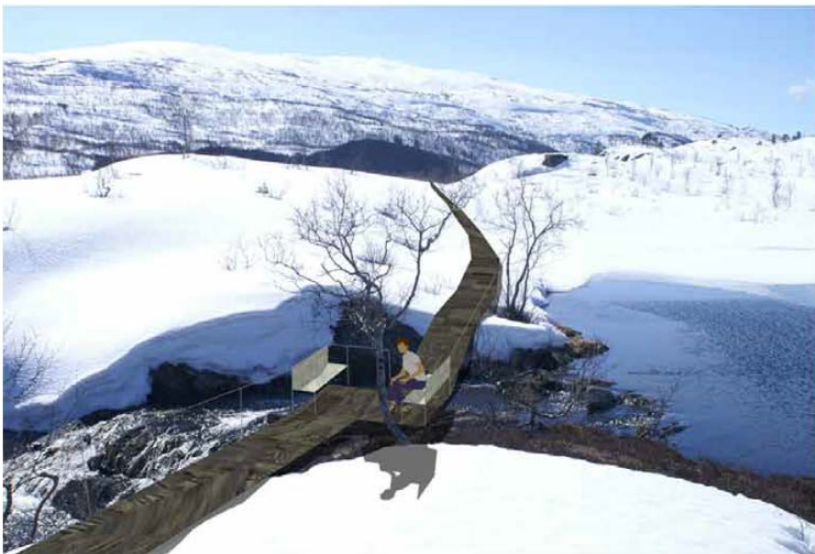
Figur 9. Bro nær Hømmervatnet. I stedet for en løsning med kryssing av elva med en enkel bru, er det foreslått et system med to bruer som møtes på steinen i midten av elva og som utformes som en rasteplass med benker. Dette gjør det mulig å stoppe opp og lytte til lyden av små fossefall (Kilde: VHSS)
