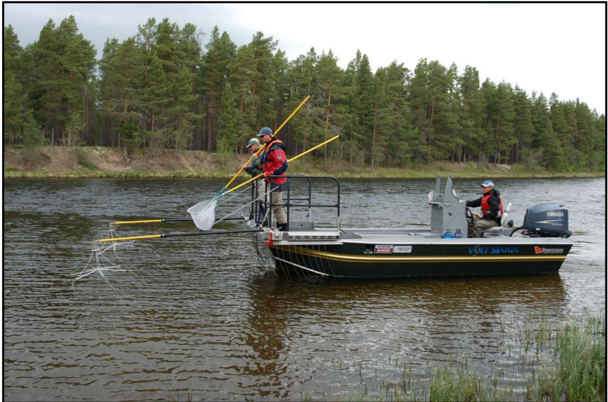
Bilde 6. Ungfiskundersøkelsene ble gjennomført ved hjelp av en 18 fots spesialbåt utviklet i USA for elektrisk fiske i store elver og grunne deler av innsjøer. Illustrasjonsfoto fra øvre deler av Glomma: Jon Museth.
