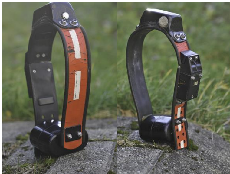
Figur 9. Foto av GPS-sender fra VECTRONICS og som er brukt i dette prosjektet. Antennen for satellitt og GSM-signaler sitter i kapselen på toppen av senderen, batteriet i den nederste ovale kapselen. Legg også merke til nummereringen på halsbåndet og den elektroniske utløserenheten på bildet til høyre som seinere er erstattet med en bruddsone i bomull.
